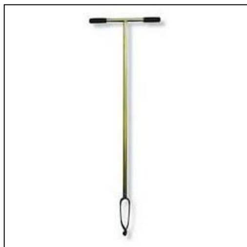
Figure 32 : Matériel utilisé pour la réalisation des sondages à la tarière manuelle
