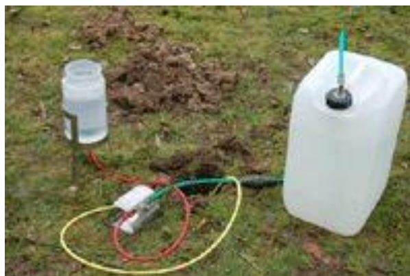
Figure 34 : Matériel utilisé pour la réalisation des tests de perméabilité
